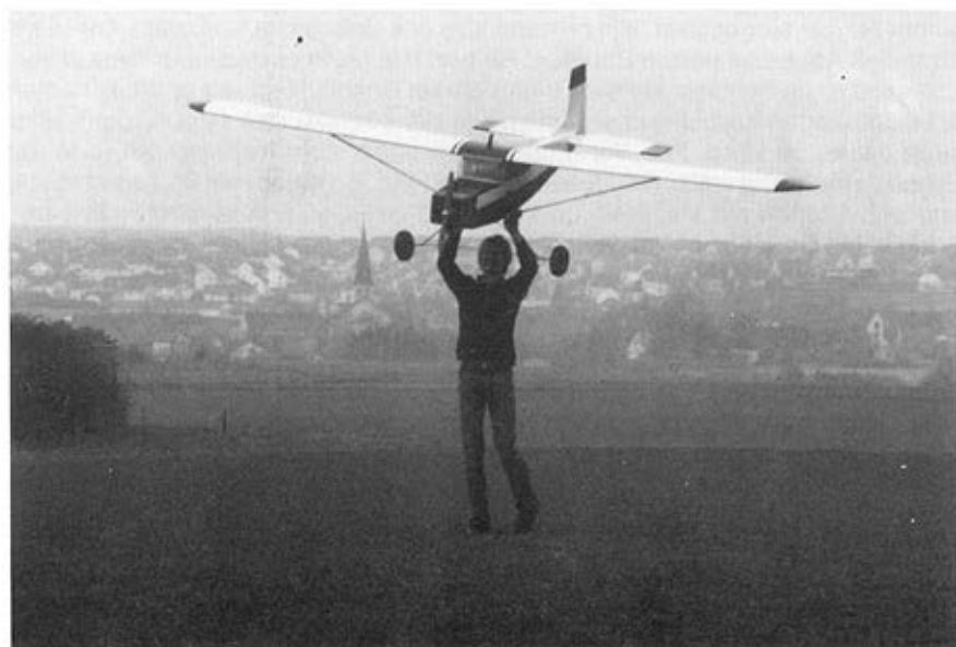
Martin Gehrmann mit seinem selbstgebauten Flugmodell; Spannweite: 3,85 m, Motorsätze: 2 PS
